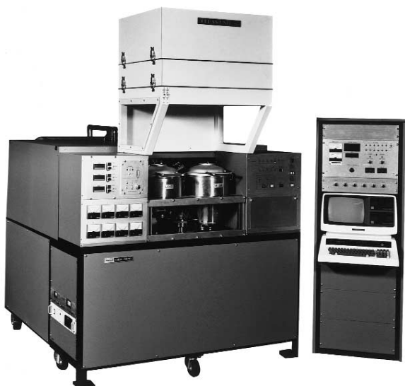
図4 枚葉式マルチチャンバー型エッチャーDEA-3016
