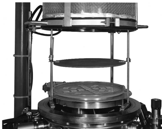
図1 実験装置のチャンバー内部構造。RF平面電極の上に石英板を載せ、その上に各種材料の試片を置いて、30分間RF放電に曝す。エッチング速度は試片の重量減少から求めた。
