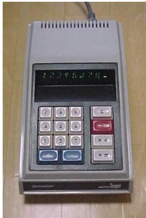
写真4 シャープが開発した世界初のLSI電卓QT-8D（1969年）
